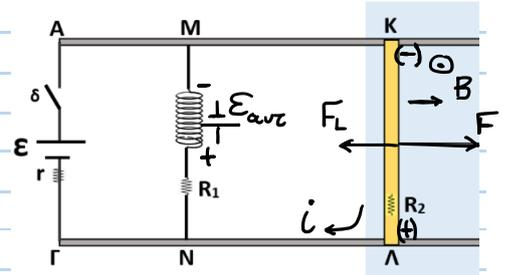
Ισχύει  $i = \frac{\mathcal{E}_{\text{επ}} - |\mathcal{E}_{\text{αυτ}}|}{R_{\text{ολ}}''} \Rightarrow \mathcal{E}_{\text{επ}} - |\mathcal{E}_{\text{αυτ}}| = i R_{\text{ολ}}''$
