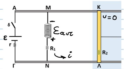
$$\text{όπως } \boxed{\frac{di}{dt} = -4 \text{ A/s}} \quad \frac{di}{dt} < 0 \text{ καθώς η ένταση του ρεύματος μειώνεται}$$
